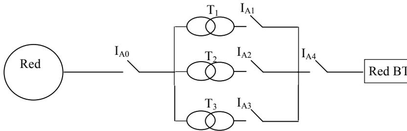
Nota: Desprecie, para el cálculo, las resistencias equivalentes de la red de MT y del transformador ( $R_r = R_t = 0$ ), tome como coeficiente de la red  $c = 1$  y considere que los aparatos conectados a la red de baja tensión no aportan corriente alguna al cortocircuito.
